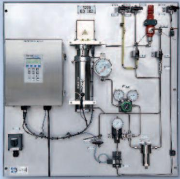
O2 Laser Poly 8 mit Probenaufbereitung
