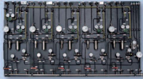
Probenaufbereitung Analysenhaus – Analytik für Silan-Synthese auf PVC-Platten laut Kundenspezifikation aufgebaut
