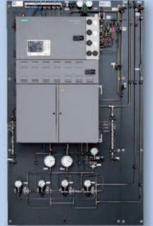
Gaschromatograph mit zwei Detektoren FID/WLD inclusive Probenaufbereitung
